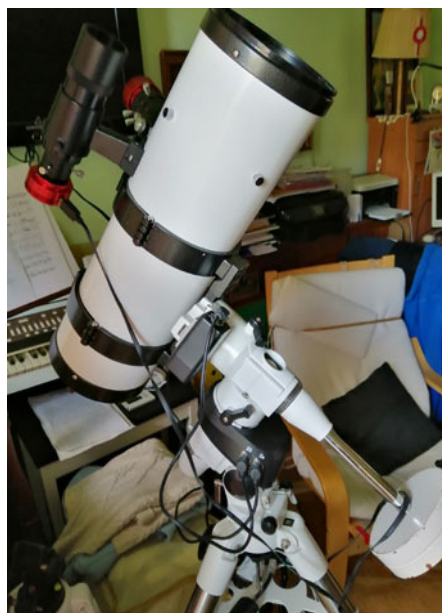
Teleskop – średnica lustra 15 cm, 60 cm ogniskowa i widoczne czerwone kamerki cyfrowe
